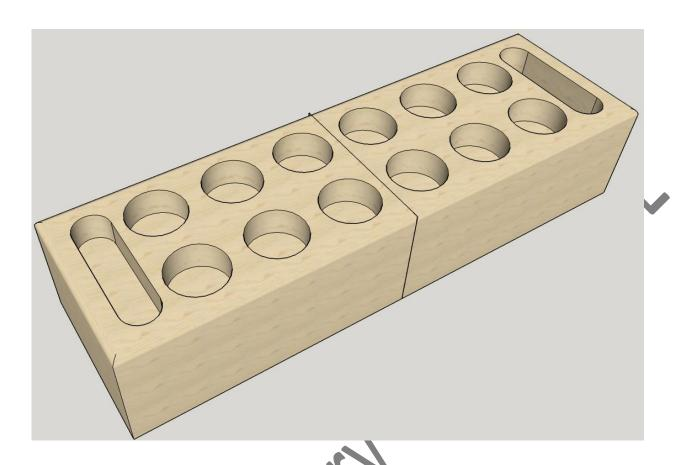
L'awalé géant a une dimension de 2.80 m de longueur par 0.75 m de largeur et 0.75 m de hauteur. Sa structure est en résineux recouvert de panneaux contre-plaque.
